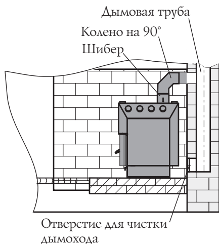
Рисунок 14. Схема присоединения котла к стационарному дымоходу
